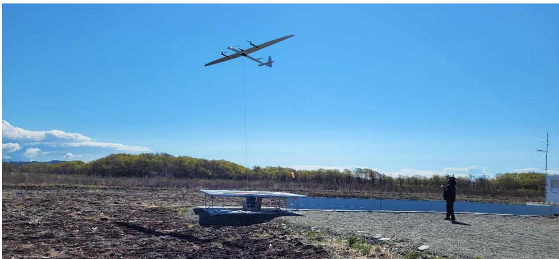
Figur 3 - Teknologiutvikling på Lista der Kitemill operer et pilotanlegg sammen med energiselskapet Sør Energi på Farsund Lufthavn. Operasjonen foregår per mai 2022 på dagtid som en del av Kitemill's testprogram, system operer automatisk og produserer energi på et tilfredsstillende nivå i forhold til skala. Operasjonstiden vil gradvis bli utvidet og det foreligger byggetillatelse til ytterligere 4 enheter, der det 2. systemet er under etablering.
